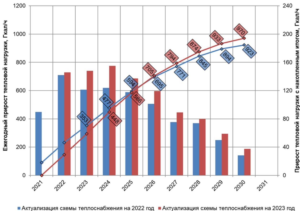
Рисунок 3.2 - Сравнение темпов прогнозируемого прироста тепловой нагрузки (для утвержденной и актуализируемой схем теплоснабжения)
